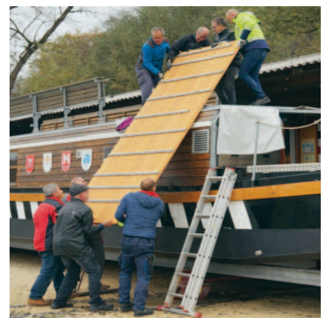
Der neue Holzbelag wird aufs Oberdeck gestemmt.
