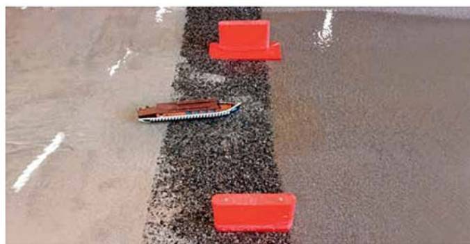
Versuchsanordnung: Der fragliche Donauabschnitt im Maßstab 1:30 wird von einem Schachtelmodell durchfahren.
